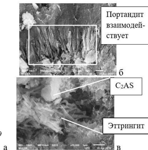
Рисунок 6 - Бинарная система геленит–гипс. Рассчитано в условиях избытка  $\text{Ca}(\text{OH})_2$  и воды при  $t=25^\circ\text{C}$  в пересчете на моль продукта (а) и продукты гидратации цемента с ДГШ (б и в). Увеличение: б -  $\times 10\,000$ , в -  $\times 15\,000$
